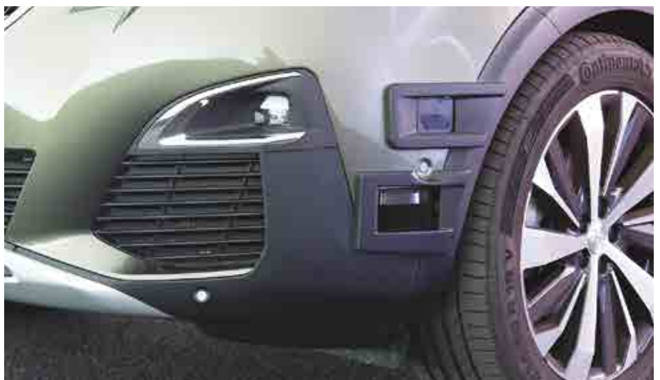
Un primo piano delle telecamere che fanno parte della dotazione delle vetture PSA.
